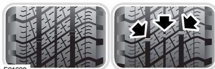
Lorsque la bande de roulement est usée d'environ 2 mm, les indicateurs d'usure commencent à apparaître à la surface des dessins de la bande de roulement. Une bande continue de caoutchouc apparaît alors sur la bande de roulement.
