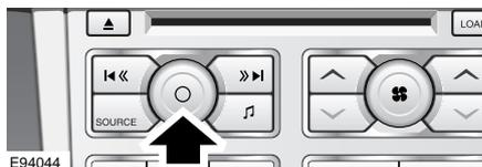
Appuyez sur le bouton marche/arrêt et du volume du panneau de commande du système audio.
