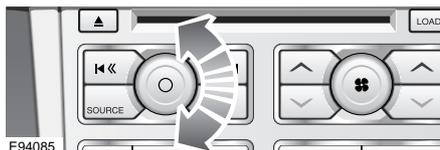
en tournant le bouton de marche/arrêt et du volume du panneau de commande du système audio ou
