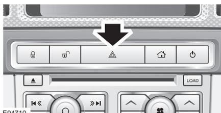
Si le véhicule est arrêté dans un endroit peu sûr ou pouvant présenter un danger pour les autres usagers de la route, allumez les feux de détresse. Pour activer les feux de détresse, appuyez sur le commutateur.
